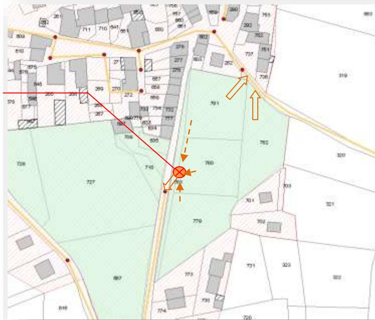
La topographie et la profondeur du réseau existant ne permettront pas aux parcelles 779 et 780 de se raccorder gravitairement au réseau existant Cami de Villeneuve. La mise en place d'un poste de refoulement doit être envisagée.
