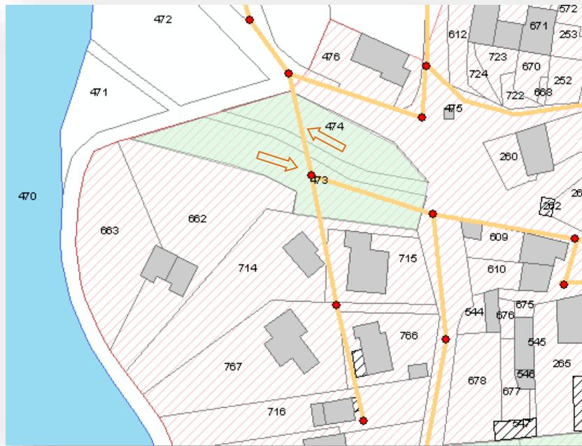
Les parcelles pourront se raccorder gravitairement au réseau existant au niveau du collecteur identifié ci-dessus.
