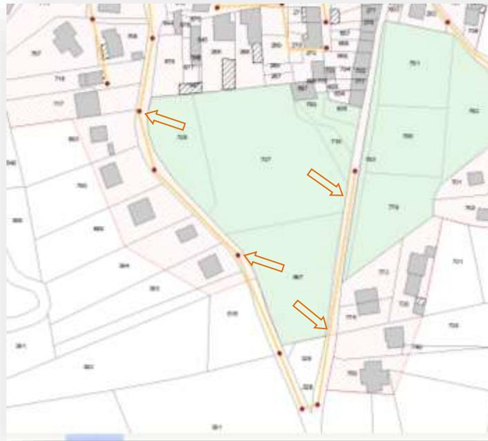
La zone pourra se raccorder au réseau existant au niveau du collecteur identifié ci-dessus.
